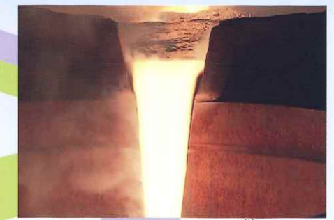
▲1600℃以上で溶かし、ゆっくり固めます。
